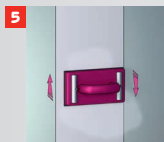
5. Lai varētu izlīdzināt šuves virsmu ar plāksnes virsmu, nogrieztās malas šuves platumam jābūt vismaz 40 cm. Kad saķerēs un izžūvis pēdējais slānis, noslīpējiet un nolīdziniet šuvi ar slīpēšanas sietiņu, kura graudainība ir vismaz 200.
